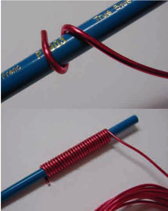
彈簧捲曲步驟 1 ：找一鉛筆當軸心，鋁線纏繞在上頭，依序慢慢纏繞至長約 10 公分的彈簧造型。
